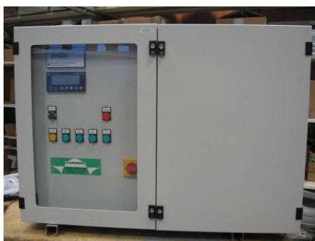
Εξωτερική άποψη γεννήτριας όζοντος για ΚΚΜ
